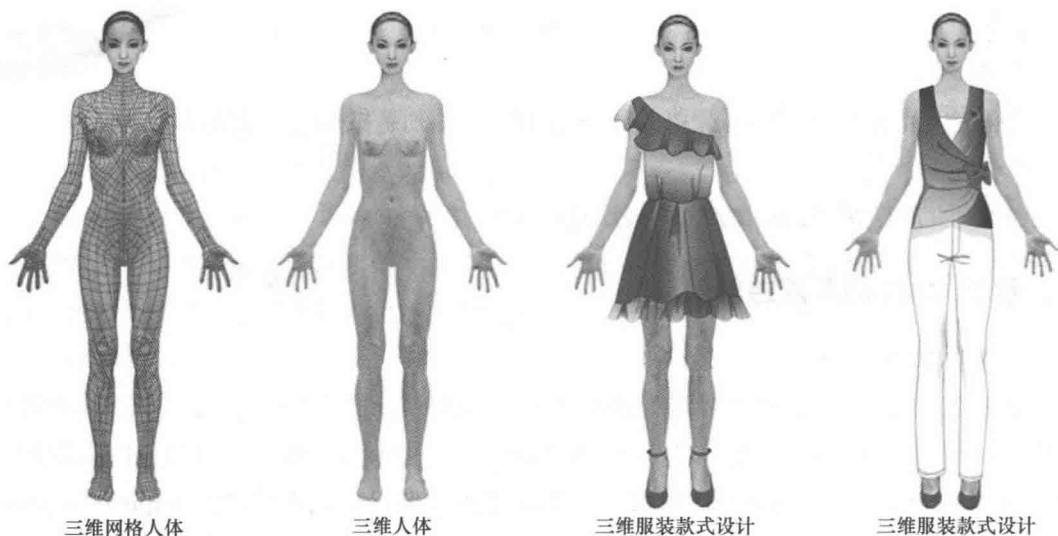
图2-19 服装VSD技术将服装样板在三维仿真模特身上模拟三维服装
